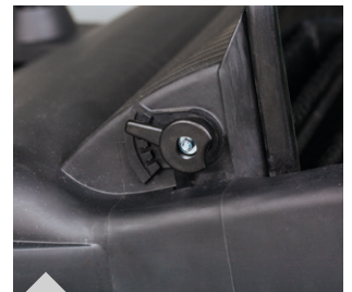
Einfache und werkzeuglose Höhenverstellung der Kehrwalzen
