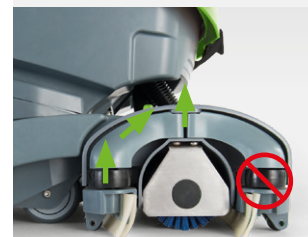
Absaugsystem mit doppelter, alternierender Absaugung (patentiert). So wird sowohl bei der Vorwärts- als auch bei der Rückwärtsfahrt das Wasser aufgesaugt
