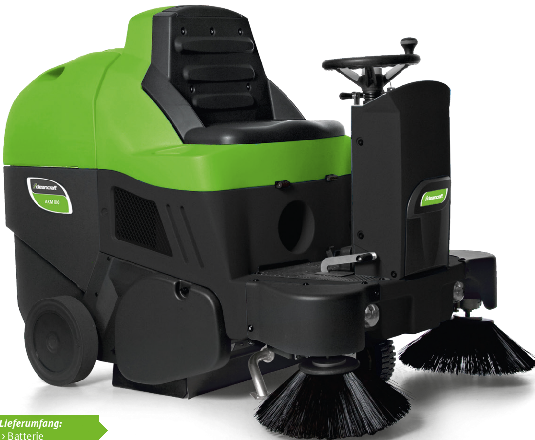
Mittel- und Seitenbürsten werkzeuglos austauschbar
