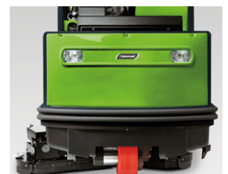
Reinigungsbürsten mit automatischem Einzug bei Stößen
