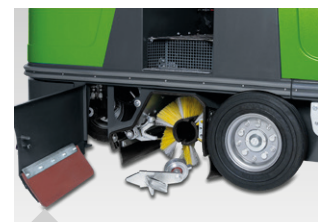
Hauptkehrwalze und Seitenbürste werkzeuglos austauschbar
