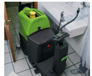
Frischwassertank mit Schlauch für Schnellbefüllung
