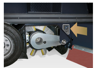
Hauptkehrwalze werkzeuglos austauschbar. Druck und Höheneinstellung der Hauptkehrwalze sind voneinander unabhängig einstellbar
